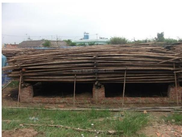
Figura 88: Detalhe do forno para defumação dos colmos
