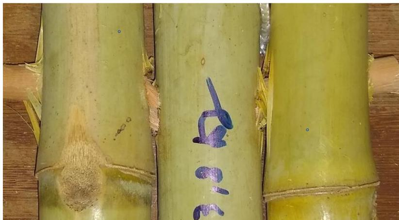
Figura 89: Detalhe da ruptura do pino
