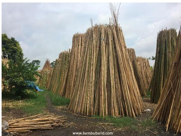
Figura 73: Secagem do bambu ao ar livre.
