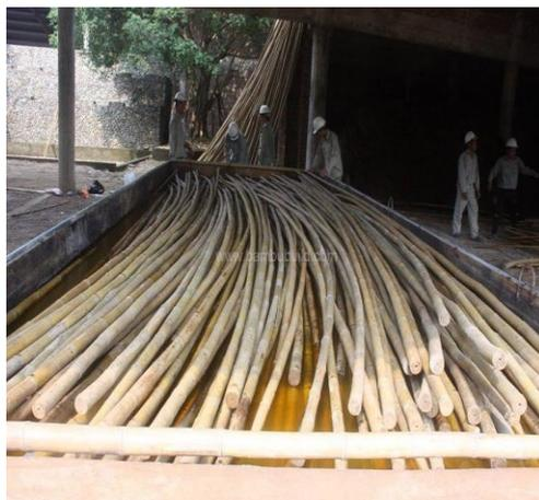
Figura 71: Detalhe do tratamento por imersão em tanque.
