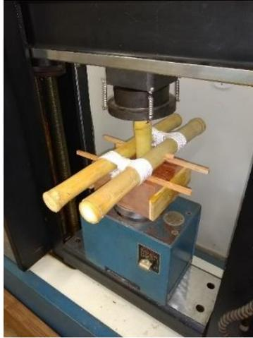
Figura 47: Ensaio das ligações perpendicular
