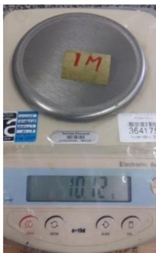
Figura 36: Pesagem da amostra a 0% de umidade
