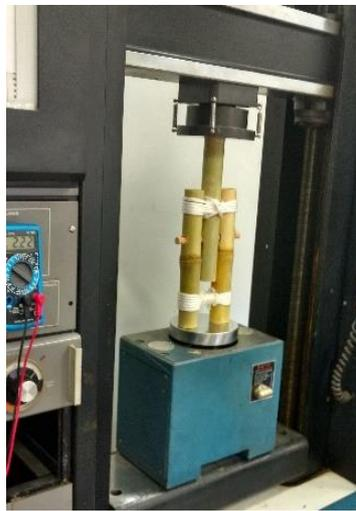
Figura 48: Ensaio das ligações Paralela
