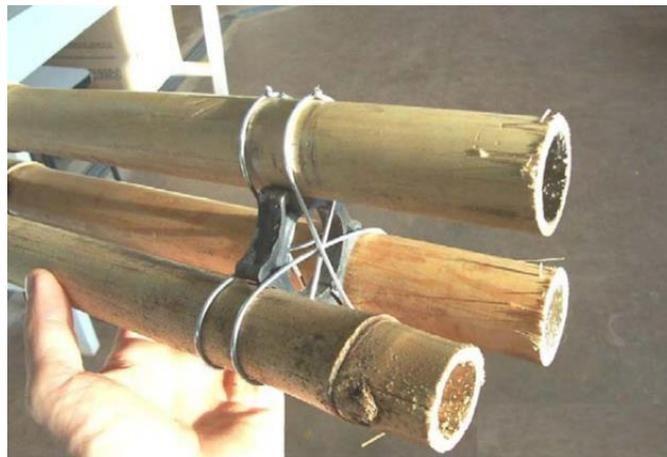
Figura 23: Detalhe da seção da peça composta de bambu.
