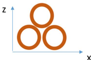
Figura 57: Seção esquemática das terças
