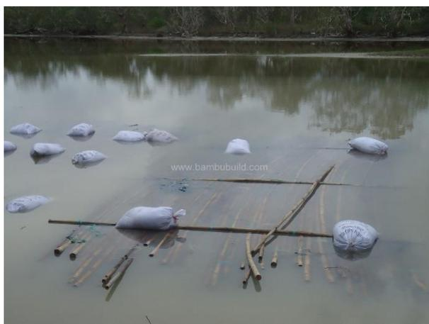
Figura 72: Detalhe do tratamento por imersão em água com alta concentração de sólidos suspensos.
